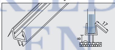
01BTPOLI012 Vinilo botaguas aleta larga con sello al piso Long: 2.50 m Para cristal: 9.5 mm
