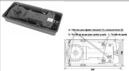
Bisagra hidráulica para 120 kg. Material cubierta: Acero inoxidable. Acabado: Satín. Medidas: Perforación de piso 145 x 299 x 50 mm.
